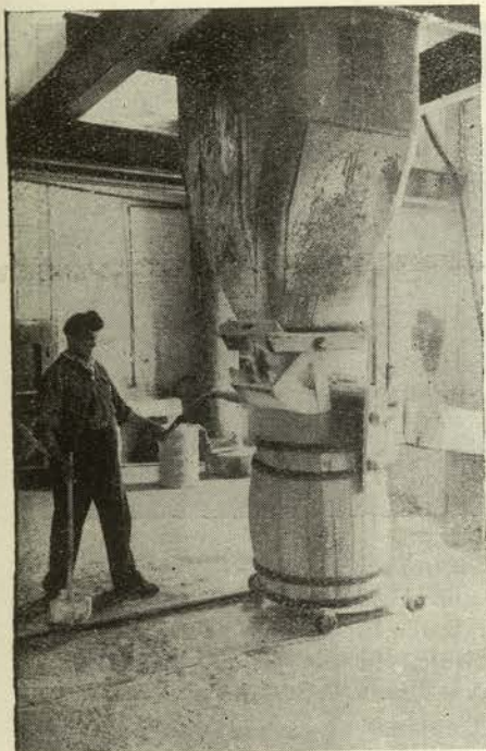
El cloruro de cal, lo que llamamos polvo de gas, va cayendo en el envase listo ya para ser vendido
