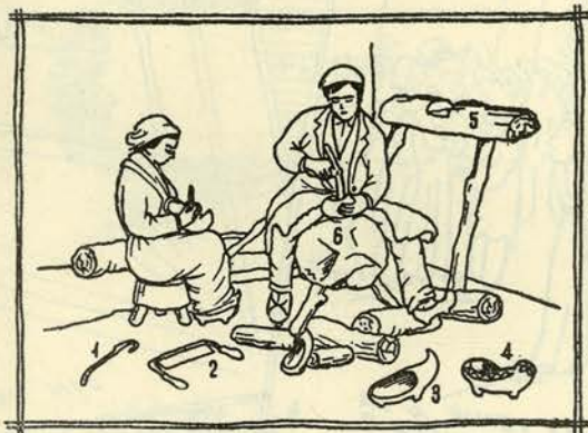
Taller de albarquero: Alisando con la azuela de peto y haciendo limuestras o bujeles. 1.º Legra o llegra. 2.º Resoria. 3.º Albarca de pico entornado o Campurriana. 4.º Bocicona o de pastor. 5.º Taladroría o juracandero. 6.º Tajón.
